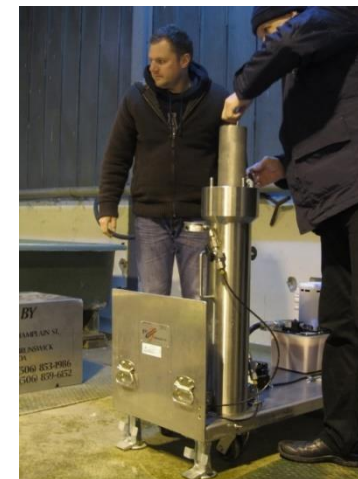
Zastosowanie szoku ciśnieniowego po zapłodnieniu: 7 500 – 11 000 psi/3-5 min/20-40 min po inseminacji
