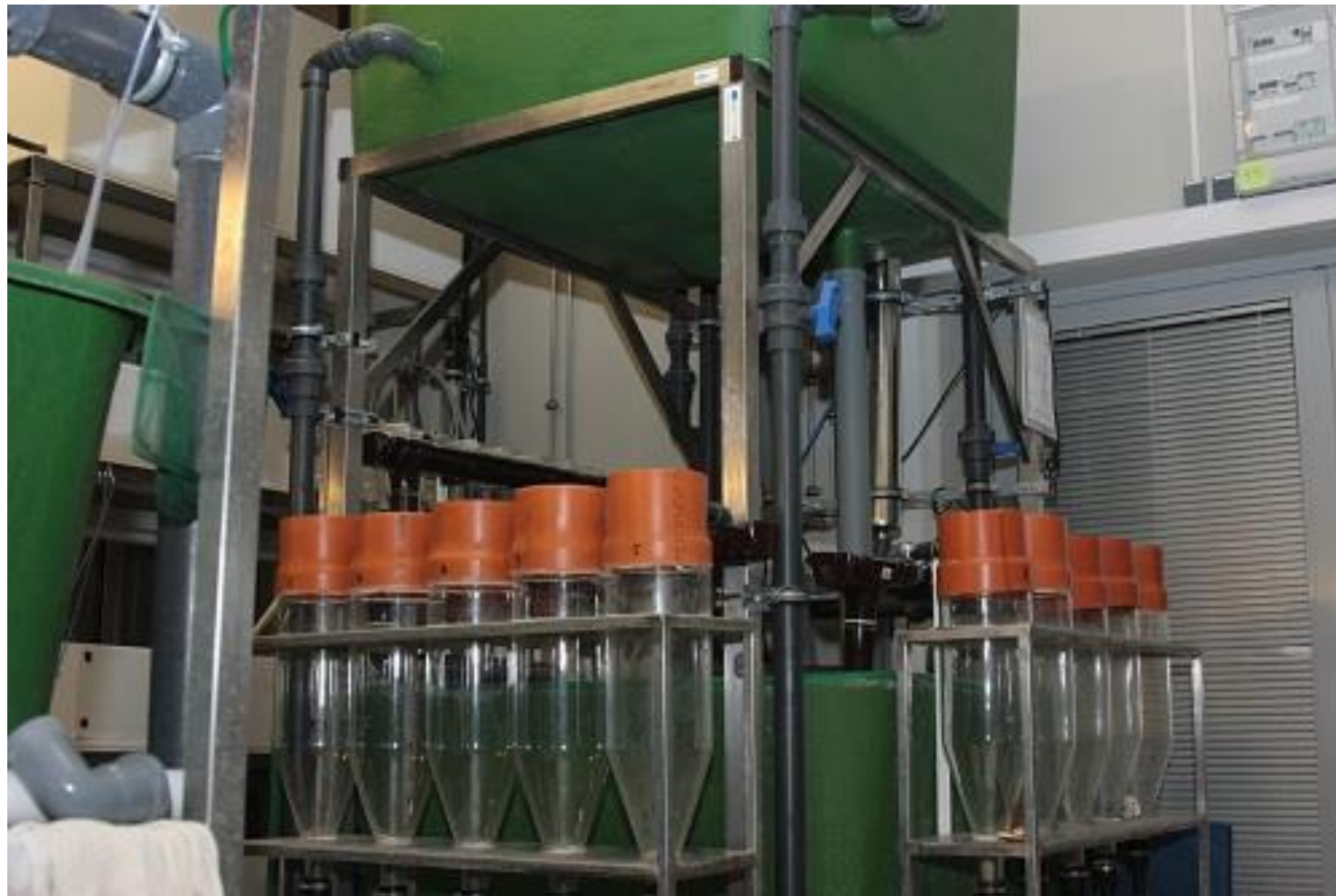
Fot. 2. RAS wylęgarniczy będący na wyposażeniu Centrum Akwakultury i Inżynierii Ekologicznej w Olsztynie.
