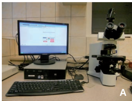
Fot. 1. Systemy komputerowe wyposażone w monitor, kamerę zintegrowaną z mikroskopem oraz oprogramowanie komputerowe firmy IHN Medical (A) oraz Hobson Vision (B) – fot. B.I. Cejko.
