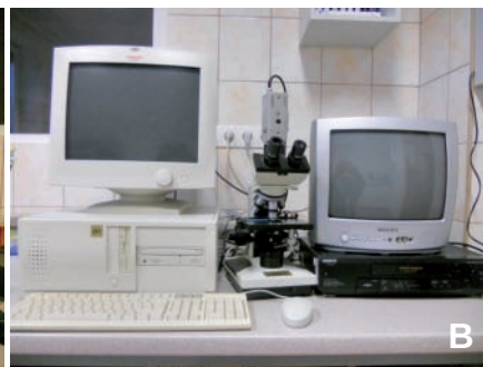
Fot. 1. Systemy komputerowe wyposażone w monitor, kamerę zintegrowaną z mikroskopem oraz oprogramowanie komputerowe firmy IHN Medical (A) oraz Hobson Vision (B) – fot. B.I. Cejko.
